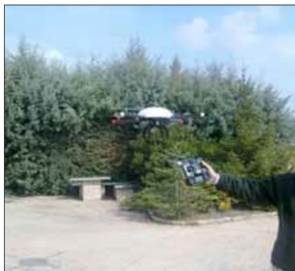
Gracias al GPS integrado se mantiene en el aire en una posición fijada en tiempo real y sin intervención del operador
