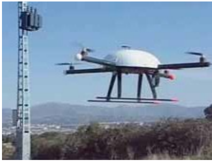
Inspección de líneas eléctricas con el "ELFO II".
